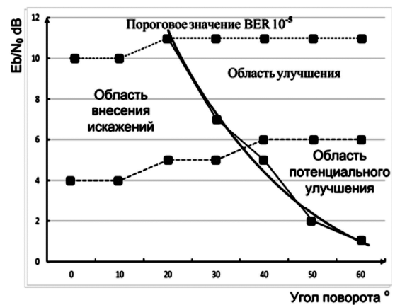
Рис. 10. Диаграмма работы алгоритма детектирования искажения и его компенсации
